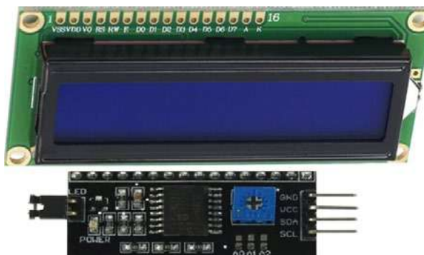
Рис. 17. Дисплей (жидкокристаллический индикатор — ЖКИ 16×2)
