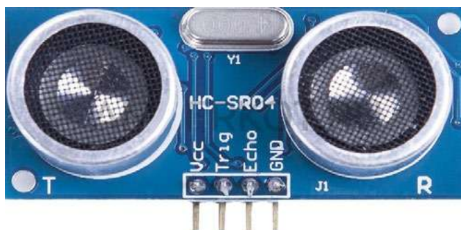
Рис. 16. Ультразвуковой датчик (дальномер)
