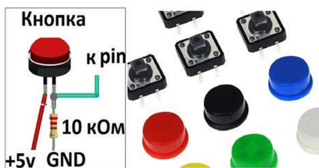
Рис. 1. Схема подключения тактовой кнопки к микроконтроллерной плате
