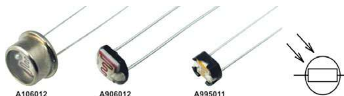
Рис. 12. Фоторезисторы и их обозначение
